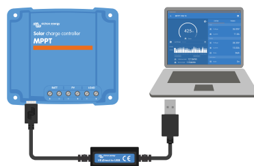
Connexion à l'application VictronConnect à travers l'USB en utilisant une interface VE.Direct-USB
